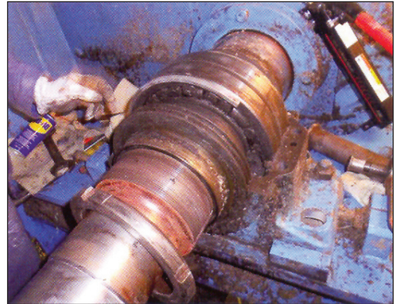
شکل ۷: شکستن یاتاقان نقاله هلیسی تفاله در کارخانه Tienen
