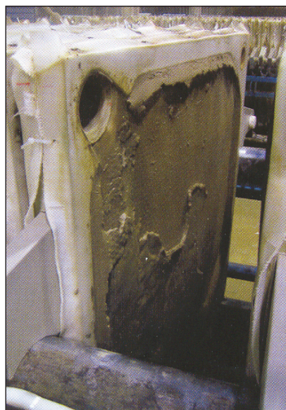
شکل ۹: مشکلات صافی در کارخانه Wanze
