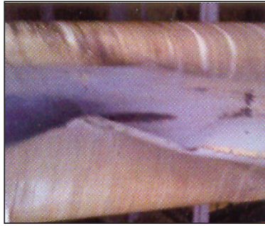
شکل ۶: ترکیب لوله بخار ورودی به کریستالیزور در کارخانه Tienen
