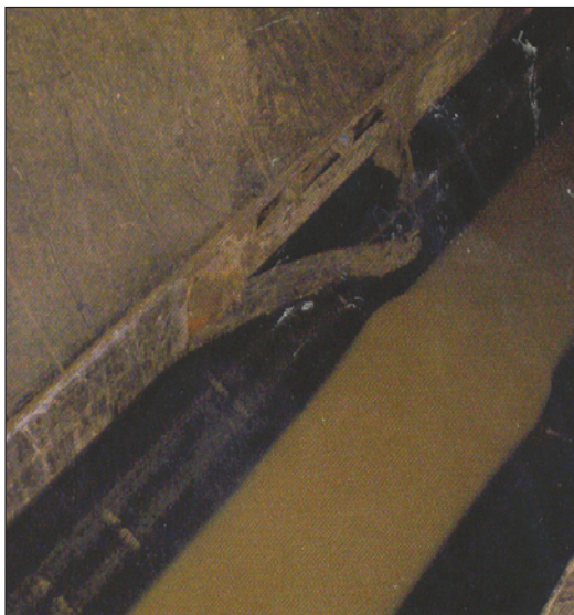
شکل ۱۱: شکستن اسکلت نقاله چغندر در کارخانه Wanze
